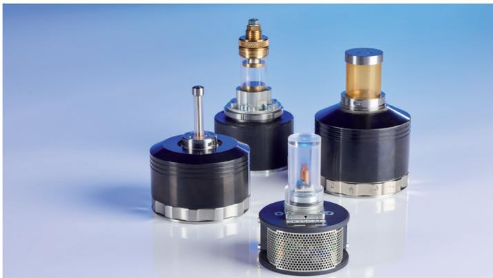
可控温（最高 +85° C，最低低于室温40° C）样品台和力学测试样品台（高达 4400 N），适用于4D成像
