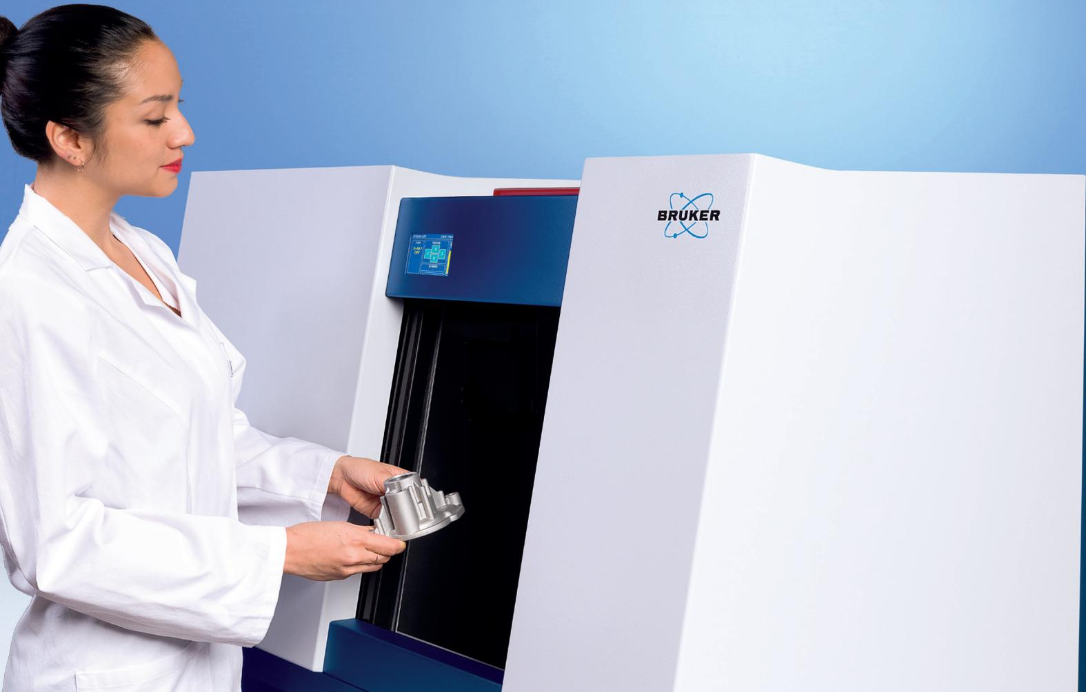
SKYSCAN 1273是新一代桌面型高分辨三维X射线显微成像系统（Micro-CT），是由布鲁克开创的一种非破坏性成像技术。SKYSCAN 1273作为一种台式设备，为非破坏性检测（NDT）树立了全新标准。它可检测长达500mm，直径达300 mm，重达20 kg的样品。
