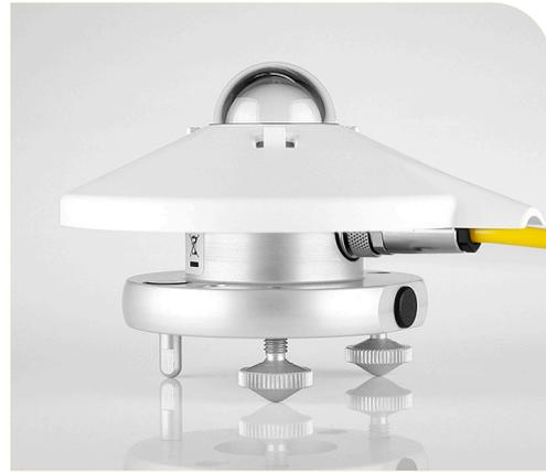
Le SMP3 est un pyranomètre à thermopile, qui diffère de la technologie utilisée dans le SCP qui est un pyranomètre à cellule de silicium. La différence est que les pyranomètres à cellule de silicium ont des erreurs élevées dans des conditions nuageuses, tandis que les pyranomètres à thermopile ont une réponse spectrale beaucoup plus large et plus uniforme, ce qui signifie qu'ils fonctionnent bien dans toutes les conditions météorologiques.
