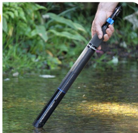
Cela signifie qu'il est idéal pour un déploiement discret à long terme, en utilisant uniquement un cordon de déploiement en Kevlar sans avoir besoin de câbles ou d'équipement auxiliaire au niveau du sol. La Maji-Sonde mesure les 10 paramètres standard et a la possibilité d'ajouter jusqu'à 6 électrodes supplémentaires sans restriction
